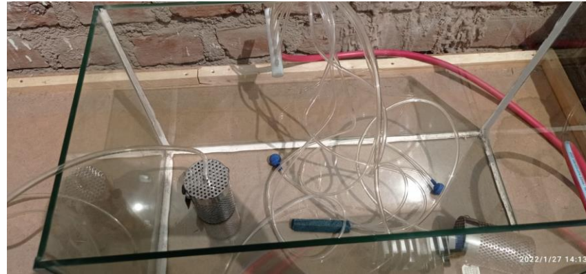
Difusores de oxigeno de tipo piedra esféricos y barra (5) Tubos PVC Manguera 4 mm
